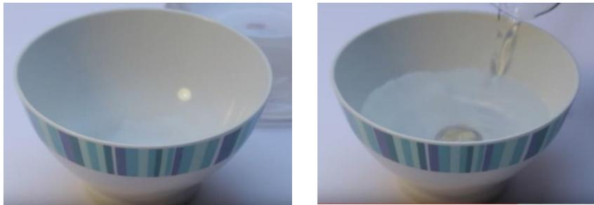
Le phénomène observé est dû à la réfraction de la lumière lors du changement de milieu eau-air. Il y a alors déviation des rayons lumineux ce qui permet de voir la pièce dans le bol en présence d'eau.
